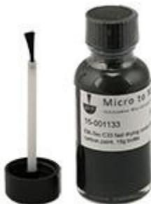
EM-Tec C32 は、微細に分散したグラフェン シート（約 1 ~ 5  $\mu$ m）を備えた、新しい水ベースの導電性グラフェン ペイントです。EM-Tec C32 グラフェン カーボンペーストには炭化水素ベースの溶剤が含まれておらず、乾燥時には高真空 (HV) システムや UHV システムにも完全に適合します。粘度が低いため、ひび割れや小さな隙間を簡単に埋めることができます。EM-Tec C32 は乾燥すると高い導電性を示します。SEM 試料の取り付けや接地経路の作成に最適です。機械的強度が低いため、サンプルは後で簡単に取り外すことができます。金属、岩石、コンクリート、セラミック、エポキシ、プラスチック、木材、繊維などのさまざまなサンプル材料に対する優れた接着特性があります。その他の用途としては、移動面の潤滑やシールドなどがあります。EM-Tec C32 には約 溶液中に 10% のグラフェンが含まれています。内容量 25g の 30cc ガラス瓶とブラシ付きキャップでお届けします。容器を摂氏 0 度以上に保ち、凍らせないでください。
