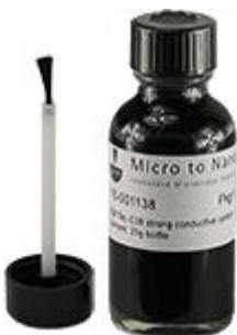
EM-Tec C38 は、微細なカーボン ブラックとグラファイト フレークをベースにし、アクリル バインダーを使用した強力な導電性カーボン セメントです。EM-Tec C38 は、金属、プラスチック、セラミック、エポキシ、ゴム、ガラス、木材、繊維などの多種多様な材料に対して優れた接着特性を示します。接地経路を作成したり、SEM サンプルをサンプルスタブに接着したりするのに最適です。丈夫なアクリルバインダーが材料の損失を減らします。永久的な試料の接着に使用できます。薄いペーストのような粘度を持っています。厚さにもよりますが、比較的早く乾燥します。65°Cまでの程度の熱を加えると乾燥がより早くなります。柔軟な表面に使用できます。溶媒はアセトンで、溶液には約 15% のカーボン ブラックとグラファイト、アクリル系バインダーが含まれています。EM-Tec C38 は、乾燥すると導電性が向上します。内容量 25g の 30cc ガラス瓶と別個のブラシで提供されます。
