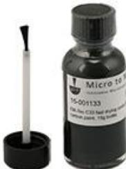
EM-Tec C33 は非常に速乾性の高い、薄いカーボンペーストです。EM-Tec C33 は、薄い導電層で大面積をすばやくカバーするために開発されました。接地経路の作成や非導電性エポキシマウントの部品の被覆に最適です。粘度が低いため、亀裂や狭い隙間を容易に埋めることができます。EM-Tec C33 は、市場で最も速乾性の高いカーボン塗料です。低い結合強度のため、試料は測定後、比較的容易に取外すことができます。EM-Tec C33 の溶媒はイソプロパノールで 10% のグラファイトとポリマーベースのバインダーが含有されています。中間の伝導率のこの製品は、内容量 15g をブラシ付きの 30cc のガラス瓶でお届けいたします。
