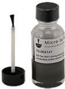
EM-Tec Ni41 導電性接着剤は、銀ペーストまたはカーボンペーストの仕様が必要ない場合の廉価で優れた代替品です。EM-Tec Ni41 は、優れた接着性、良好な導電性、手頃な価格の優れたアクリル系セメントです。カーボンペーストと銀ペーストと同様の強くて丈夫なアクリルバインダーを使用しています。カーボンペーストと銀ペーストの中間の導電性を持っています。試料スタブへの SEM 試料の永久的な接着に使用されています。EM-Tec Ni41 は、薄いペーストの粘度を有します。ペイントの厚さによっては比較的速く乾燥し、また、65°Cまでの適度な熱で乾燥時間を短縮することができます。広範囲の試料に使用可能です。溶剤はアセトンで、50%のニッケルとアルカリ系バインダーを含有しています。乾燥すると非常に良好な導電性が有ります。ブラシ付の 30cc のガラス瓶に内容量 25g が入っています。
