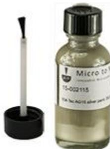
EM-Tec AG15 は、希釈剤として MEK/アセトンを使用した熱可塑性樹脂バインダーを含む、非常に細かい銀フレークをベースとした導電性銀塗料です。EM-Tec AG15 は、Acheson / Henkel の EDAG 1415M および DAG 915 と完全に同等です。用途としては、SEM サンプル、電子およびシールド用途のための接地パスと導電性接着剤として使われています。プラスチック、セラミック、ガラス、金属、木材、ゴム、エポキシ、繊維などの幅広い材料に対して良好な接着特性を実現します。低粘度の銀ペーストは、接地トラックの作成やサンプルスタブ上の SEM サンプルの接着に最適です。サンプルは簡単に取り外せます。この銀ペーストは塗料のような粘度を持っています。厚さにもよりますが、比較的早く乾燥します。70°Cまでの加熱で乾燥時間を短縮します。溶液には 57.5 ~ 59 % の銀が含まれています。EM-Tec AG15 は優れた導電性を示します。ブラシ付きの 30cc ガラス瓶、25 グラムで提供されます。
